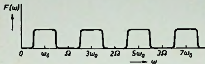
Bild 2. Die Frequenzcharakteristik eines idealen Wandlers, bestehend aus einer Anzahl linienförmiger äquidistanter Schallquellen (Abstand \frac{1}{2}p ), ist eine periodische Funktion. Die Periode \Omega ist gleich 2\pi v/p ; v ist die Ausbreitungsgeschwindigkeit der Oberflächenwellen. Die Durchlaßbereiche bei \omega_0, 3\omega_0, 5\omega_0, usw. sind in diesem Fall alle symmetrisch und untereinander kongruent. Bei einem realen Wandler sind die Durchlaßbereiche infolge der endlichen Breite der Finger nicht mehr untereinander gleich. Bei Wandlern mit w = \frac{1}{4}p fehlt z. B. der Durchlaßbereich bei 3\omega_0 .
