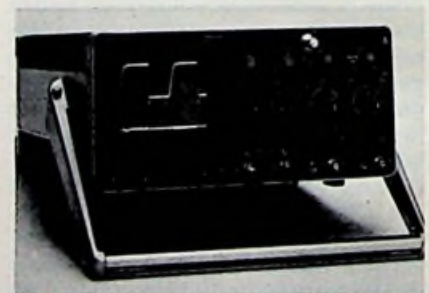
Ein 40-MHz-Multiplizierer ist in das Oszilloskop PM 3243 von Philips eingebaut
